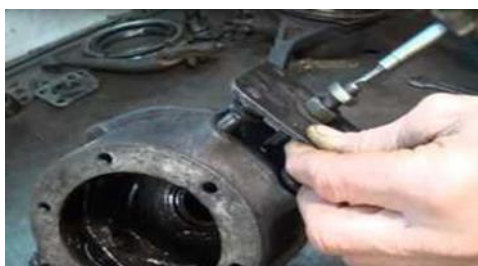
Рис.2 Процесс выпрессовки шкворня.
