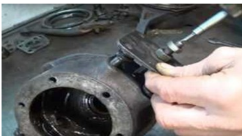
Рис.2 Процесс выпрессовки шкворня.
