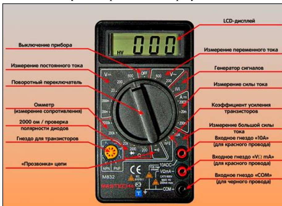
Рис.2 Элементы лицевой панели цифрового мультиметра
