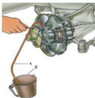
Рис. 86. Удаление воздуха из гидропривода колесных тормозных механизмов: 1 – шланг для прокачки; 2 – сосуд для тормозной жидкости
