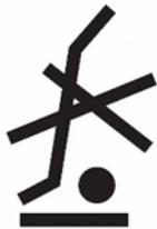
Поднимать тележкой запрещается. Указывает места, где нельзя применять тележку при подъёме и перемещении груза.
