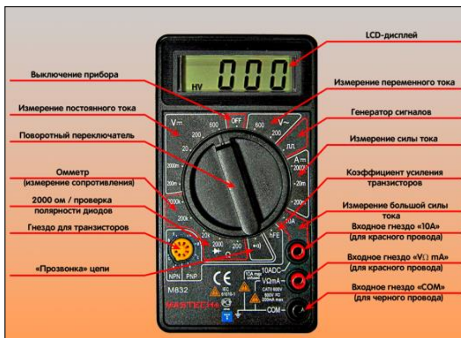
Рис.2 Элементы лицевой панели цифрового мультиметра
