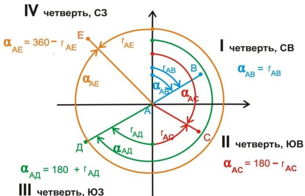
3.7. По дирекционному углу (азимуту) исходной стороны  $A_{\text{пред}}$  и примычному углу  $\beta_{\text{изм}}$  вычислить последующий дирекционный угол  $A_{\text{посл}}$ :
