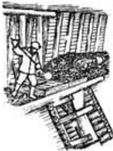
Рисунок 11. Забутовка угля на предохранительной решетке
