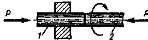
Рис.8. Сварка трением: 1 – неподвижная свариваемая деталь; 2 – вращаемая свариваемая деталь
