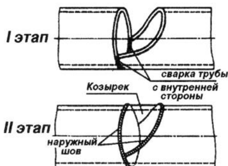
Рис.1 Порядок сварки стыков труб козырьком
