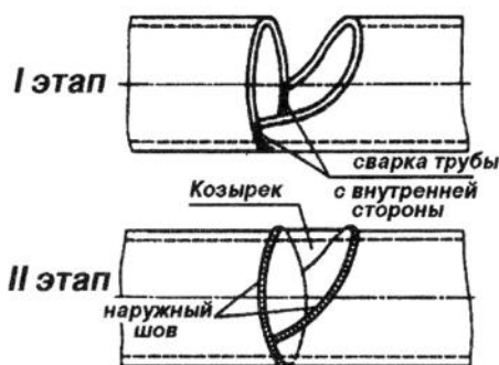
Рис.1 Порядок сварки стыков труб козырьком
