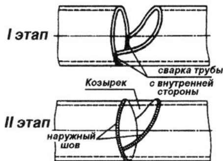
Рис.1 Порядок сварки стыков труб козырьком
