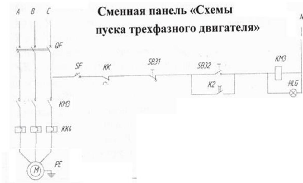
М - Асинхронный двигатель с короткозамкнутым ротором 3-хфазный 0.5кВт
