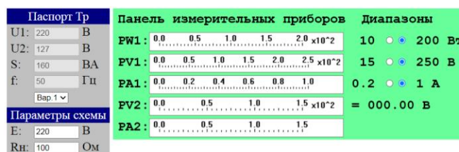
Рис 1. Паспортные данные трансформатора и панель измерительных приборов
