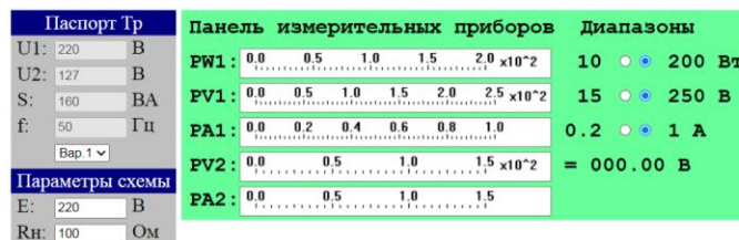
Рис 1. Паспортные данные трансформатора и панель измерительных приборов
