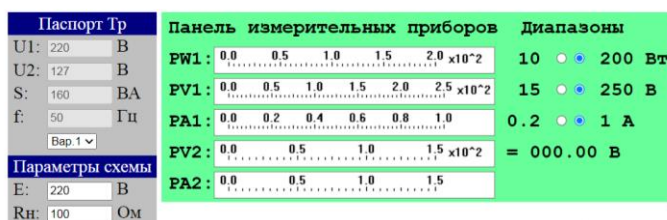
Рис 1. Паспортные данные трансформатора и панель измерительных приборов
