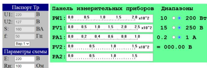
Рис 1. Паспортные данные трансформатора и панель измерительных приборов
